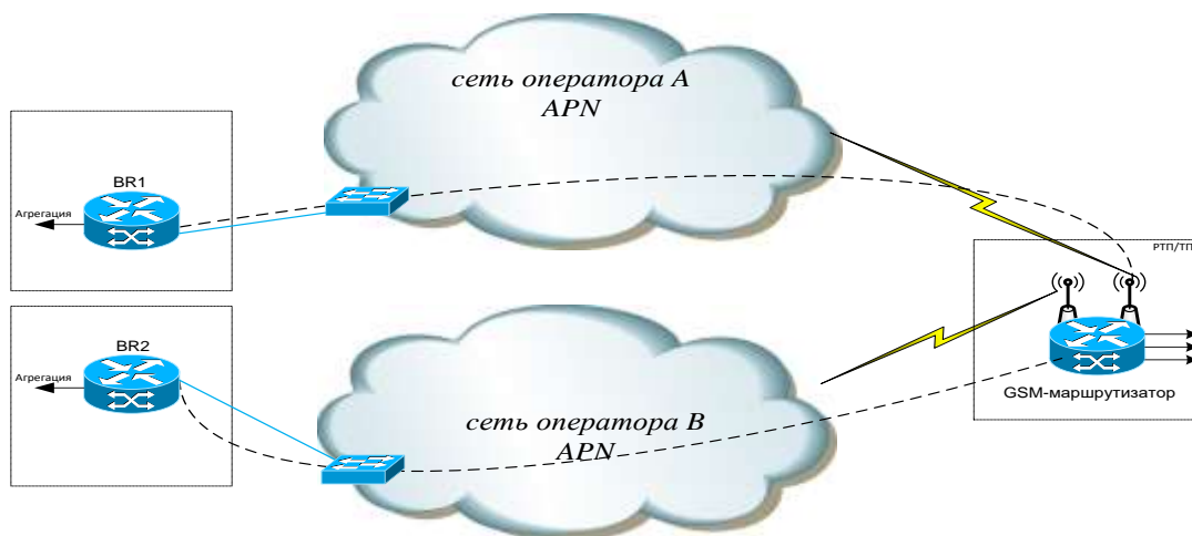
Рисунок 8. Участок беспроводной сети по APN
